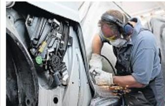
Das war nur mit dem Ersatz der ganzen Seitenwand (Aussenblech) machbar, was die Instandstellung im Gegensatz zu einer nicht korrekten Reparatur ziemlich verteuerte. Das passte der Versicherung nicht. Sie wollte, dass entgegen den Herstellerangaben geschweisst wird, um die Kosten tief zu halten.
